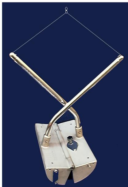
La benna Van Veen è un campionatore di fondo di largo impiego sia perché è efficace su ogni tipo di sedimento sia perché è di semplice impiego. Se utilizzata su profondità elevate (50 m od oltre) oppure in zone di corrente, la benna dovrà essere appesantita.
