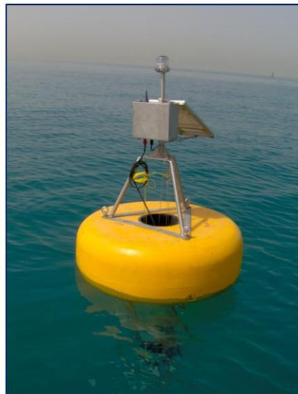
La prima realizzazione interna, di un sistema completo, si ha nel 1990 con un'importante rete per il monitoraggio marino in Sicilia: 5 boe, ciascuna equipaggiata con strumentazione oceanografica, ed una stazione meteorologica di terra, tutte collegate via radio ad un unico Centro di controllo.
