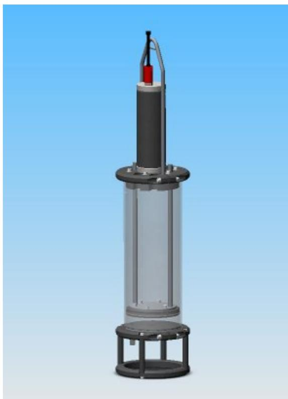
Il campionatore IWS (Integrating Water Sampler) permette la raccolta, in continuo ed automaticamente, di un campione distribuito lungo una colonna d'acqua, in accordo alle richieste della EU-WFD.
